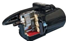
La flecha de acero inoxidable y engranajes bañados de aceite eliminan problemas de motor, el cual está sellado contra el agua por el fabricante y puede funcionar sumergido.
